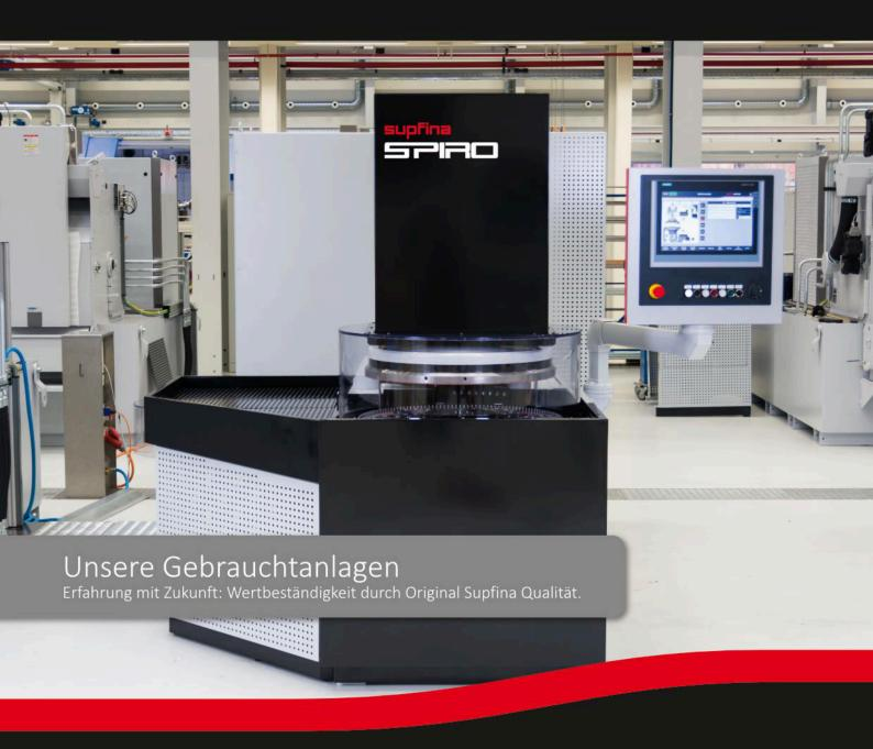
Flexible Feinschleif-Maschine zur Erzeugung von präzisen Planflächen
